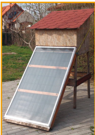
2. kép: napkollektoros aszaló
